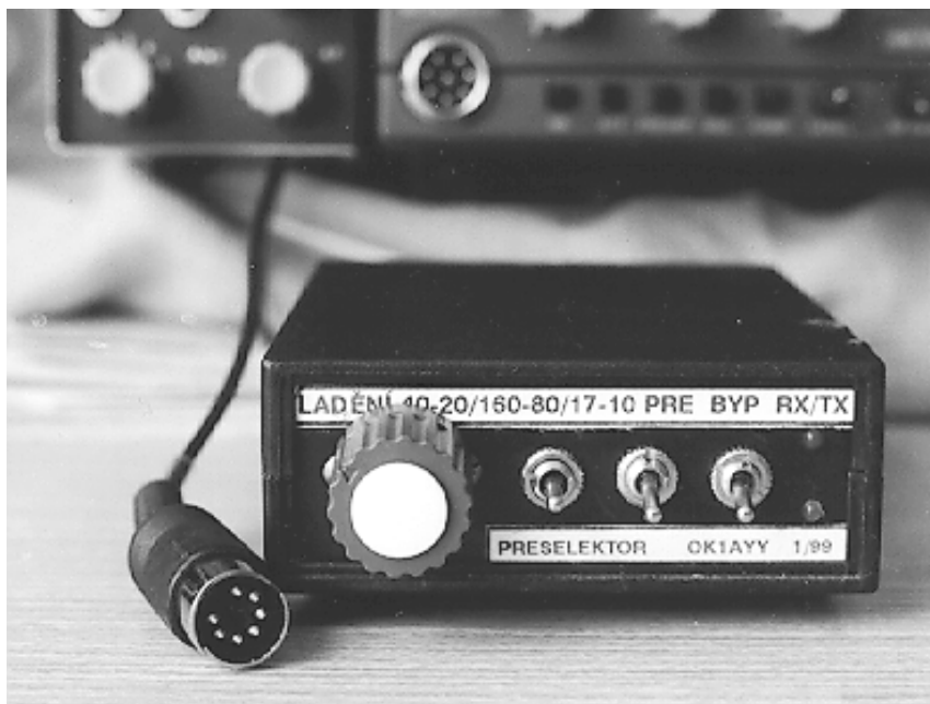
Obr. 2. Pohled na kompletní preselektor
