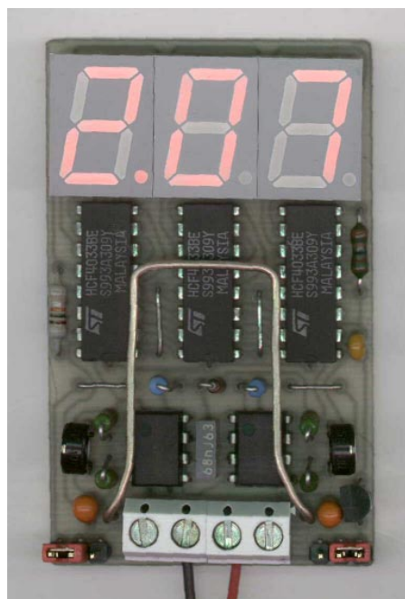
Obr. 3. Pohled na osazenou desku měřiče náboje
