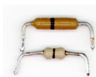
Obr. 5. Jedním černým proužkem značený rezistor není nic jiného než propojka
