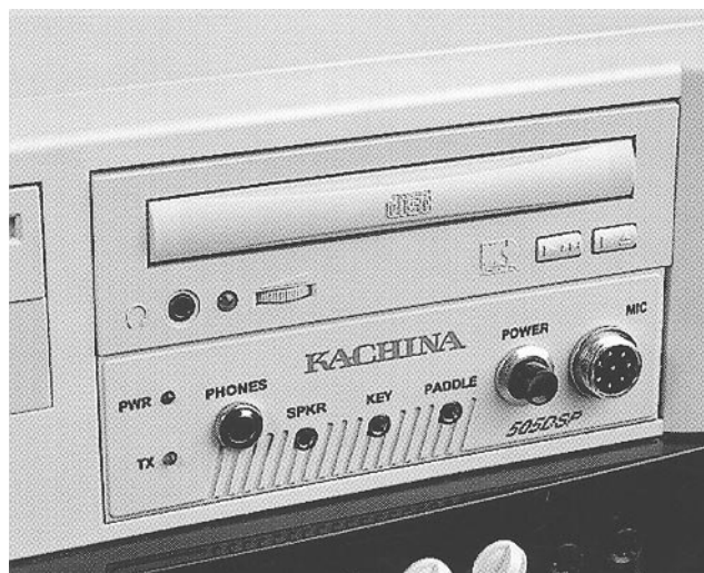
Ovládací část transceiveru. Rozměr čelního panelu je shodný s mechanikou 5 1/4" floppy disku i s krytem
