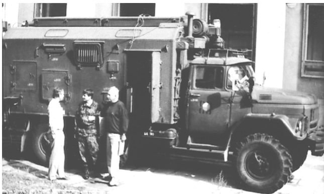
Vlevo: Armádní spojaři pod vedením pplk. E. Kaplana, OK1UUK, demonstrovali v Holicích radiovůz se stanicí R161 all mode pro pásmo 1,5 až 60 MHz sovětské výroby (němečtí turisté marně nabízeli veliteli, aby radiovůz prodal do jednoho z německých muzeí). Vpravo: Bez problémů si však mohli koupit radiostanici čs. výroby typu A7B z 50. let na bleším trhu
