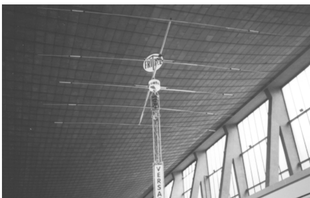
Anténa Fritzl typu FB-53 pro pásma 14, 21 a 28 MHz
