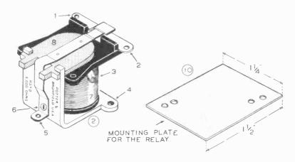
THE RS5D POTTER & BRUMFIELD RELAY AND THE SUB-BASE FOR THE RELAY
