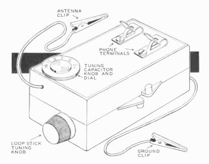
A POCKET-SIZE VERSION OF THE SOLAR-POWERED RADIO RECEIVER
