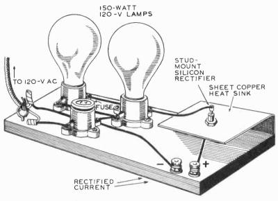
A HOMEMADE, 2-AMPERE HALF-WAVE RECTIFIER
