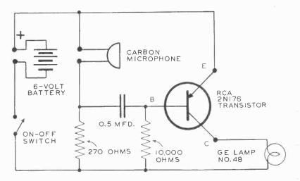
SCHEMATIC CIRCUIT DIAGRAM FOR PHOTOPHONE TRANSMITTER
