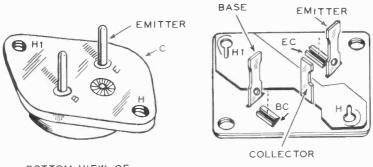
BOTTOM VIEW OF POWER TRANSISTOR
