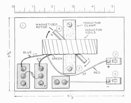
PLAN OF THE SUN-POWER TRANSISTOR MOTOR
