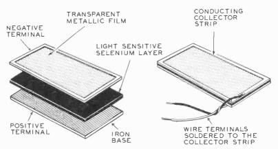
SELENIUM PHOTOVOLTAIC CELL CONSTRUCTION
