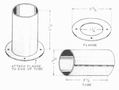
DETAILS OF SHIELD FOR PHOTOCELL AT RECEIVER
