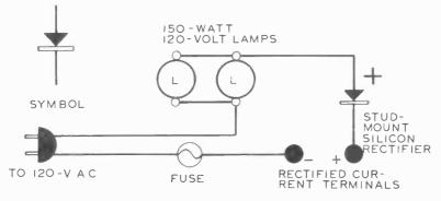
SCHEMATIC CIRCUIT DIAGRAM FOR HALF-WAVE RECTIFIER
