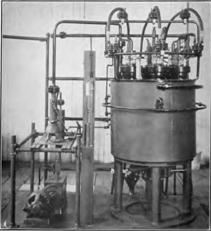
FIGURE 18.—Modern iron-tank rectifier.
