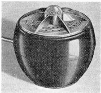
FIG. 11 (below).—"DIAPHRAGM-TYPE CRYSTAL MICROPHONE.
