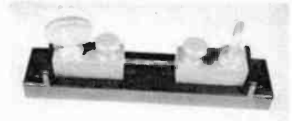
Fig. 22-17. A 10-ampere, 50-millivolt ammeter shunt.
