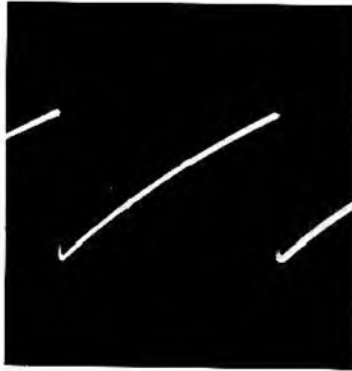
Photo 1. — Forme de la tension sur l'émetteur de l'U.J.T.
