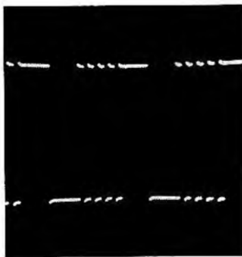
Photo 5. — Signal rectangulaire 1500 Hz wobblé par un signal rectangulaire à 150 Hz.
