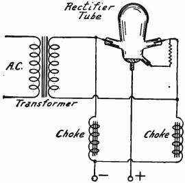
Circuits of Mercury Arc Rectifier.
