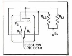
Fig. 5: Circuit shows neg. Gm
