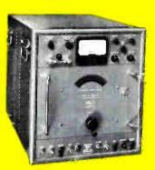
EXTENDED RANGE MICROWAVE RECEIVER Model R 400 to 22,000 mc
