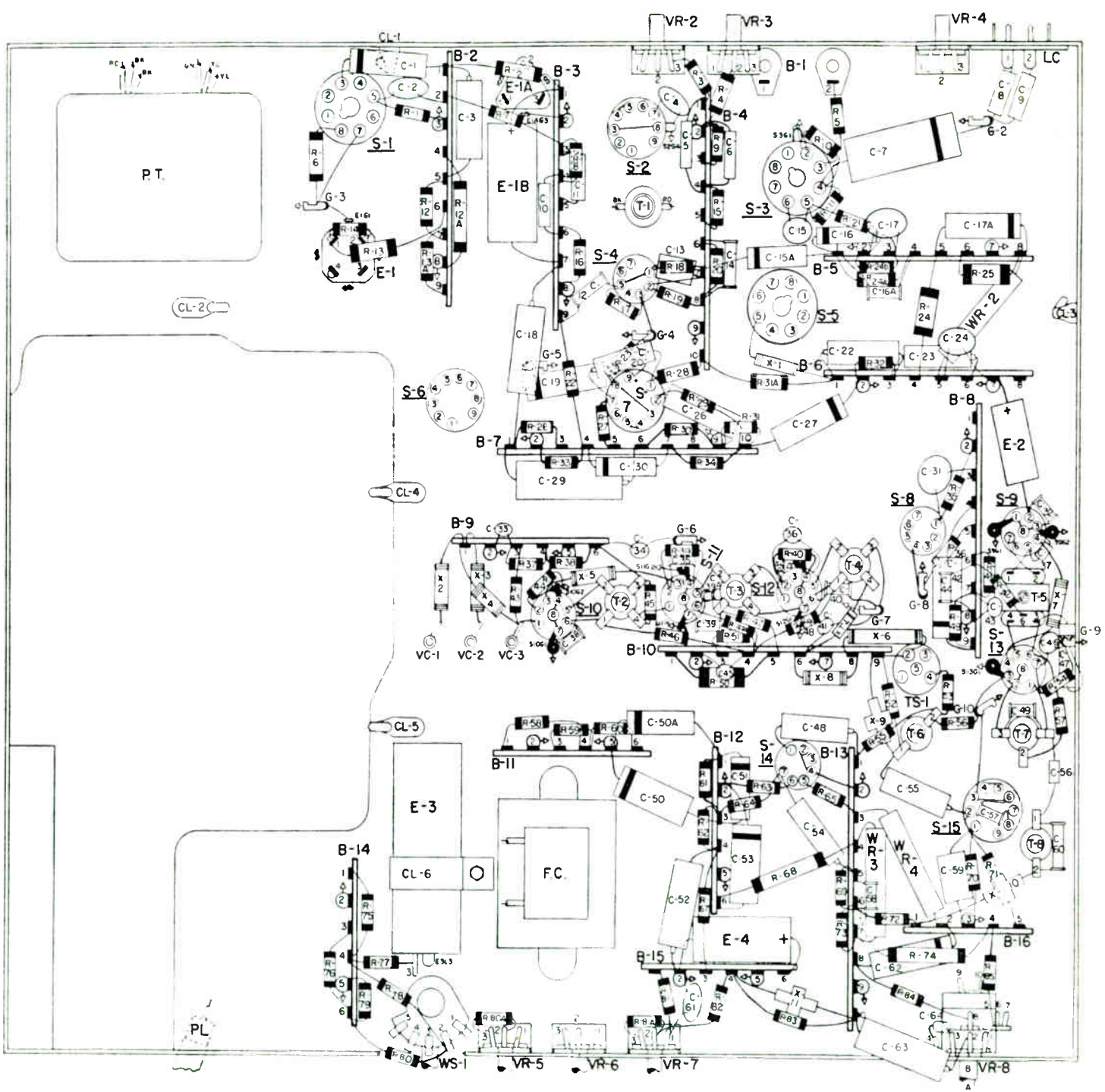
Fig. 28. Wiring Diagram, bottom view — TV-354 chassis.
