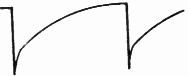
PIN 5 (V12) 6CD6G HORIZ. OUTPUT 65 VOLTS PP
