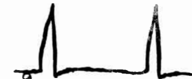
PIN 9 T4 HORIZ. WIDTH COIL 250 VOLTS PP
