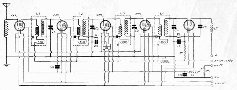
THE CIRCUIT OF THE MB-29, A SCREEN GRID AMPLIFIER WHICH IS ONE OF THE MOST SENSITIVE TUNED RADIO FREQUENCY TUNERS EVER DESIGNED.
