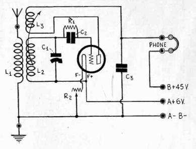
FIG. 20 A ONE TÜBE RECEIVER USING REGENERATION.
