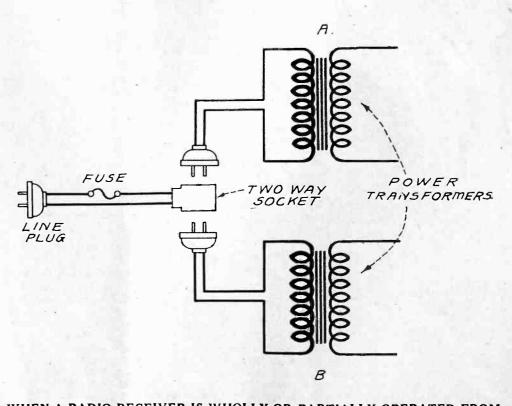
WHEN A RADIO RECEIVER IS WHOLLY OR PARTIALLY OPERATED FROM SOCKET POWER A ONE AMPERE FUSE SHOULD BE PUT IN THE SUPPLY LINE TO PROTECT THE INSTALLATION AGAINST SHORTS AND OVERLOADS RADIO WORLD
