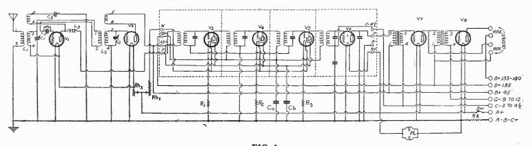
FIG. 1 THE CIRCUIT DIAGRAM OF THE EIGHT TUBE SCREEN GRID LABORATORY MODEL SUPER-HETERODYNE
