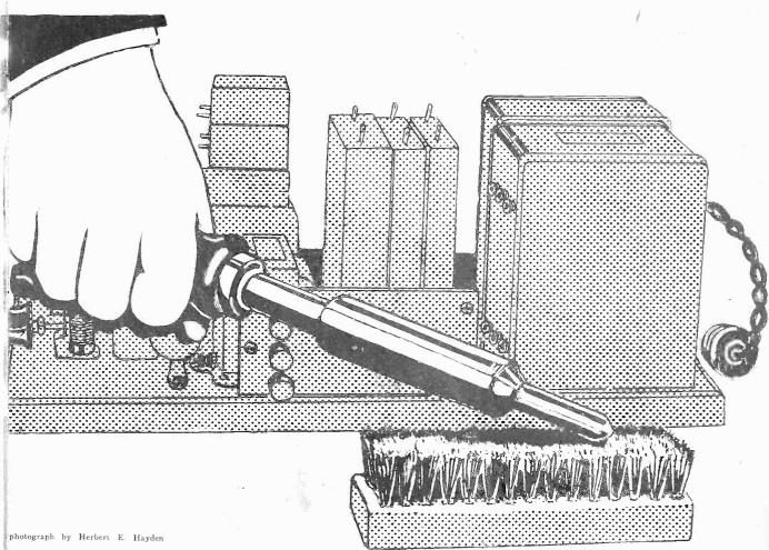
EAN OFF THE TIP OF YOUR IRON ON A WIRE BRUSH NAILED DOWN FOR SECURITY
