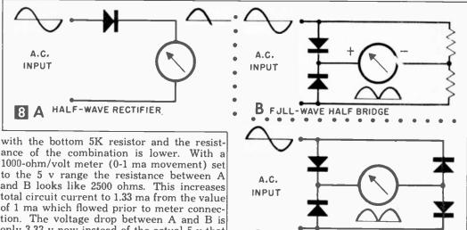
Meter rectifier circuits.
