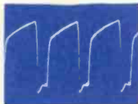
15. PIN 6, V305 180V P-P 22. PINS 1, 8 V101 150V P-P
