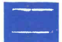
32 A701-8 10V P-P Horiz. Rate Demod Reference
