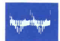
34 A701-4 7V P-P Horiz. Rate Demod Output
