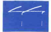
15 V502-8 400V P-P Vert. Rate Plate Vert. Oscillator
