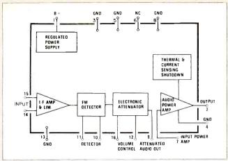
Fig. 2-Sound IC block diagram.
