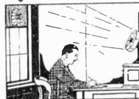
Desk Fan aiding Exhaust Fan in Ventilating
