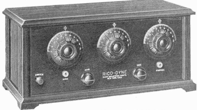
AUTO BALANCED 5-TUBE RADIO FREQUENCY
