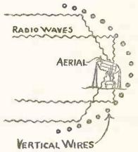
Fig. 3. A Radio Reflector
