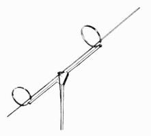
Figure 36. Duo-dipole antenna.
