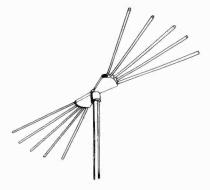
Figure 45. Multi-channel fan antenna.
