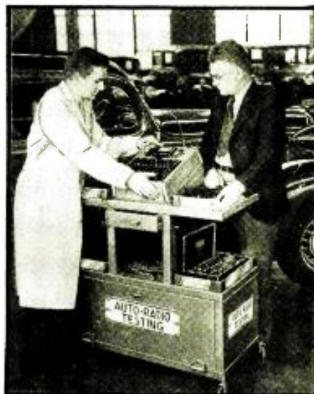
A complete auto-radio checking unit.
