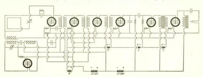
A SENSITIVE SEVEN-TUBE SUPERHETERODYNE CIRCUIT
