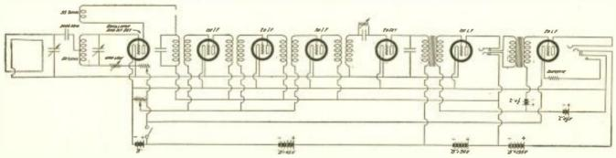
A SEVEN-TUBE SUPERHETERODYNE CIRCUIT
