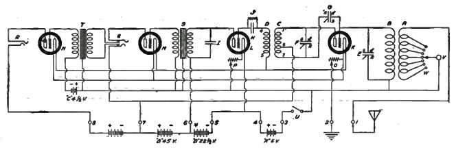
THE CRAIG CIRCUIT, EMPLOYING THE PRINCIPLE OF TUBE-CAPACITY **NEUTRALIZATION**
