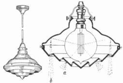
LIGHT FITTING EMBODYING A NEW PRINCIPLE OF DISTRIBUTION
