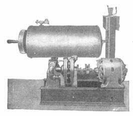
AUTOMATIC PUMP FOR STEAM HEATING SYSTEM
