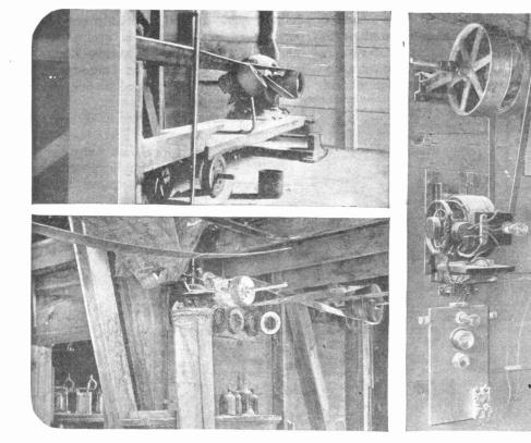
FIG. I. THE DYNAMO IS DRIVEN FROM THE MILL SHAFT BY A QUARTER TURNED BELT
