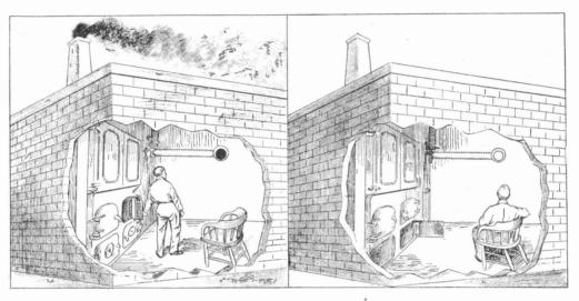
A GLANCE AT THE GROUND GLASS INDICATOR SHOWS WHETHER STACK IS SMOKING OR NOT
