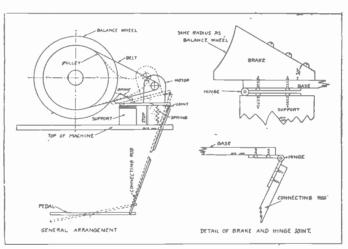
SEWING MACHINE MOTOR AND BRAKE
