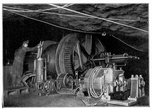
HOW THE ELECTRIC MINE LIFT IS OPERATED
