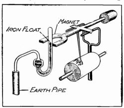
APPARATUS FOR RECORDING TERRESTRIAL PRESSURES
