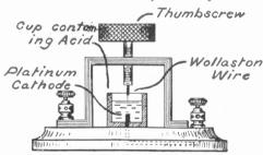
FIG. 113. SIMPLE ELECTROLYTIC DETECTOR
