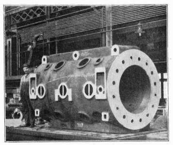
SHOWING THE SIZE OF A GAS ENGINE CYLINDER
