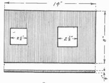
FIG. 98. FIBRE HEAD
