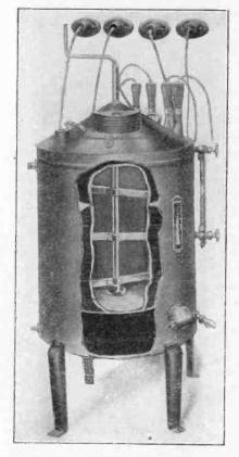
FIG. 2. GLUE HEATER OF 50 GALLONS CAPACITY
