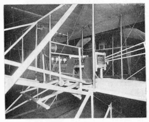
THE ORIGINAL WRIGHT AEROPLANE FITTED WITH WIRELESS APPARATUS
