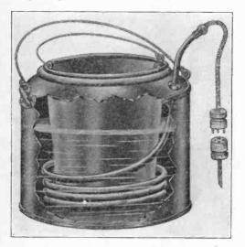
FIG. I, SIMPLE ELECTRIC GLUE HEATER
