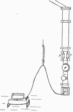
FIG. 16. ELECTRIC PRESSING IRON CIRCUIT
