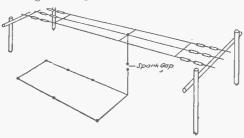
GENERAL ARRANGEMENT OF THE ANTEN-NAE ON THE AEROPLANE
