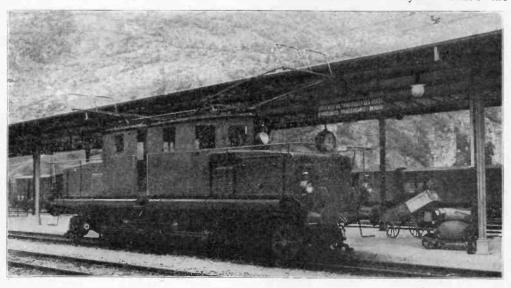
ELECTRIC LOCOMOTIVE OF THE SIMPLON TYPE
