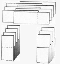
FIG. 24. FITTING ON THE ENDS OF THE CORES
