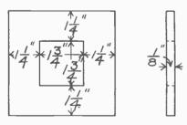
FIG. 22. WOODEN RETAINING PIECES
