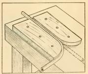
Fig. 2. Work Bench Conduit Bender
