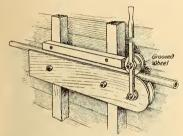
Fig. 1, Plank and Lever Conduit Bender
