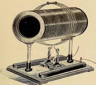
FIG. 13. HIGH FREQUENCY SOLENOID.
