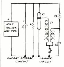
Fig. 2. Basic flash-tube circuit.
