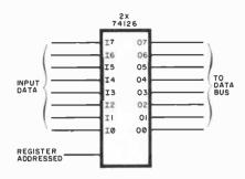
Fig. 3. Simple input port.
