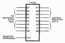
Fig. 2. Simple output port.
