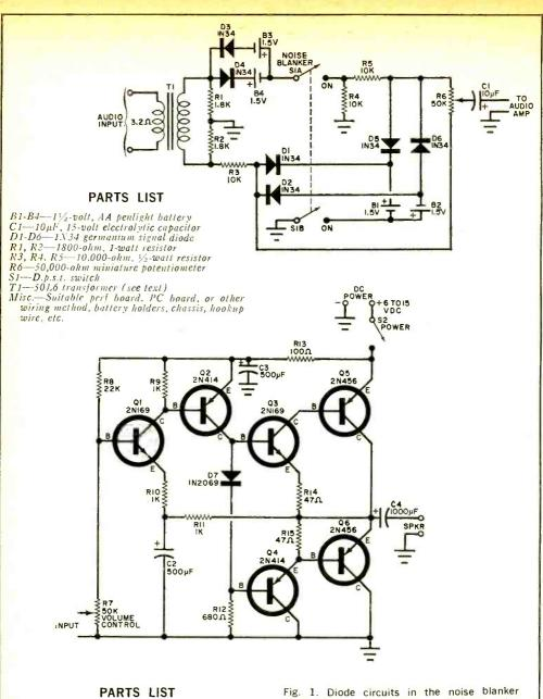
C2, C3-500-µF, 15-volt electrolytic capacitor C4—1000-µF, 15-volt electrolytic capacitor D7—1N2069 silicon rectifier diode Q1, Q3—2N169 transistor Q2, Q4—2N114 transistor Q5, Q6—2N156 transistor R7-50,000-ohm potentiometer R8-22,000-ohm R9, R10, R11-10,000-ohm R12—680-ohm R13—100-ohm All resistors 1/2-watt
