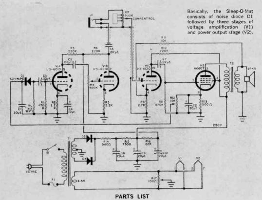
C1, C2—20-uf., 50-volt electrolytic capacitor
