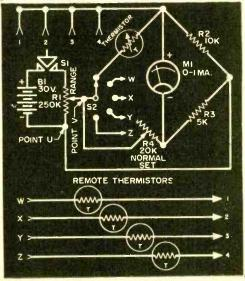
R2—10.000-ohm, ½-watt resistor R3—5000-ohm, ½-watt resistor R4—20.000-ohm potentiometer, "normal set" control
