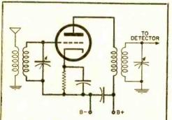
Fig. 1. Triode r.f. amplifier circuit.
