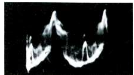
Fig. 2. IF waveform using demod probe.
