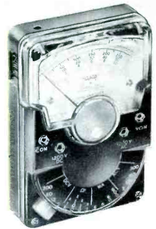
Fig. 3. Triplet Model 310 VOM.
