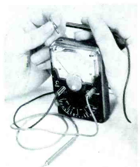
Fig. 3. Triplet Model 310 VOM.
