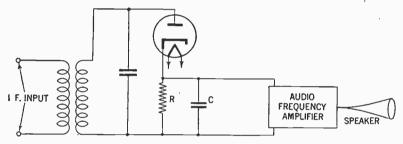
FIG. 21-Diode detector circuit.
