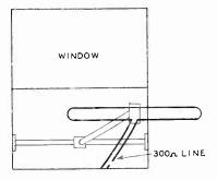
Fig. 13. Window type antenna.
