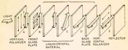
FIGURE 2. UNENERGIZED REFLECTIVE LCD.
